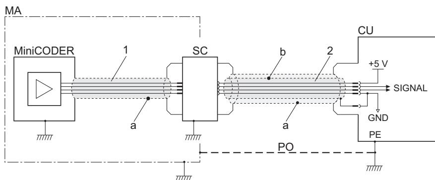
MiniCODER mit Schalttafel-Einbaudose (17-polig)
